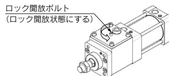
ロック状態であることを確認し、ロックユニットの開放ポートに0.3MPa以上のエアを供給時にロック開放、排気時にロック状態となり、かつロック開放状態において、最低作動圧でピストンロッドが引っ掛かることなくスムーズに作動することを確認します。
